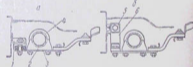
Фиг. 41. Крепление глушителя: а — до изменения; б — после изменения; 1 — кронштейн; 2 — болт; 3 — кронштейн выхлопного конца глушителя; 4 — труба; 5 — накладка; 6 — ремень
